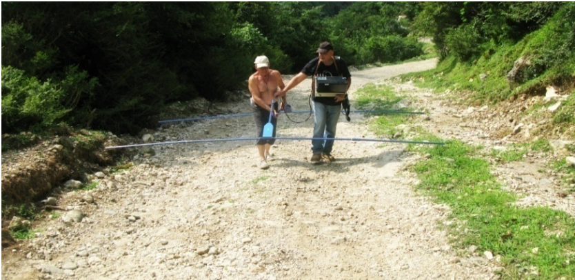
სურ. 23. მდ. ხობისწყლის ხეობაში გამავალი საავტომობილო გზის 150 მ სიგრძის მონაკვეთზე ჩატარებული პირველადი გეორადიოლოკაციური გამოკვლევები (ფოტოზე ავთანდილ თარხან-მოურავი და დავით ოდილავაძე)
